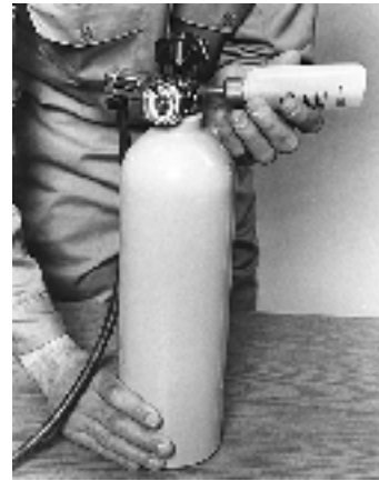
FIGURE 10 Recherche de fuites
