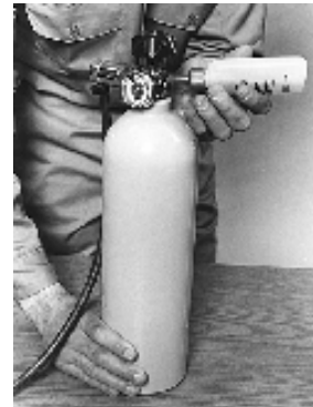
FIGURA 10 Revisión para Detectar Fugas
